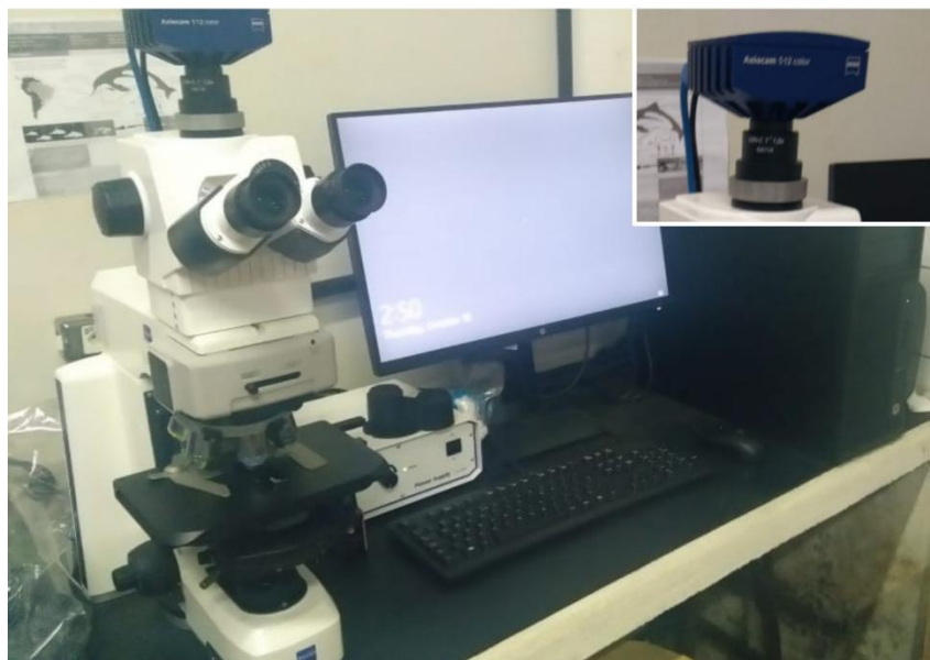
Figura 11 Microscópio trinocular com Iluminação Halogena para diferencial de contraste de interferencia (DIC) com câmera acoplada, com destaque na câmera.
