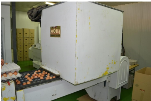
Слика бр. II.9 Хауба (кабина) за контрола (лампирање) на јајца
