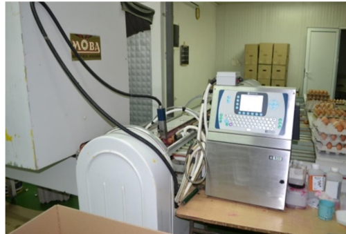
Слика бр. II.10 Машина за означување код на јајца
