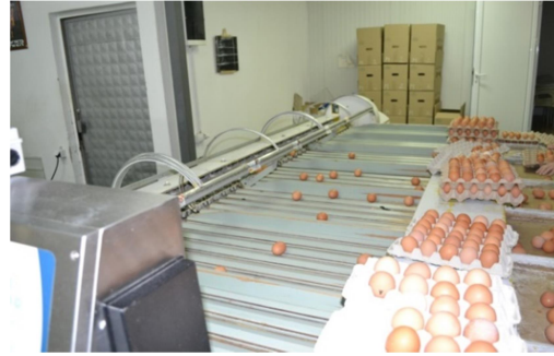
Слика бр. II.8 Приказ на систем за сортирање на јајца
